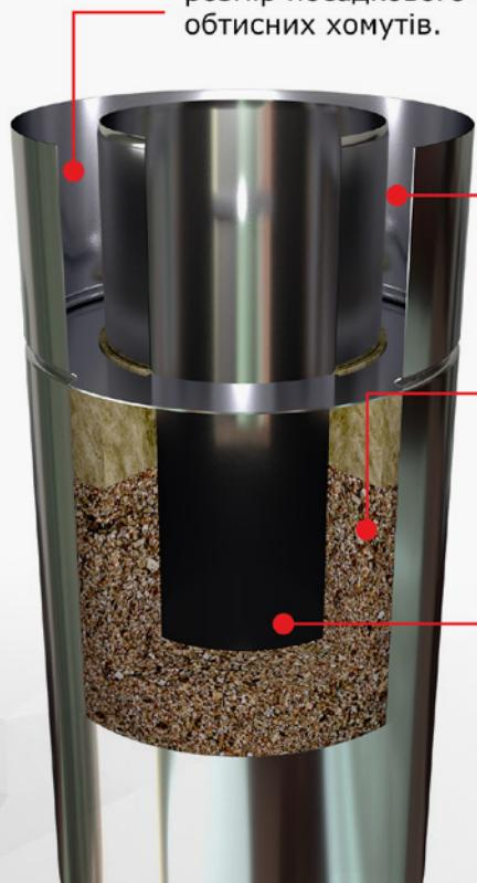
**1** Для збирання димоходів СТАЛАР використовується розтрубна система з'єднання труб за методом холодного формування. Це єдина правильна система, що дає звуження димового каналу і не перешкоджає видаленню відпрацьованих газів. Також в димоходах «СТАЛАР» розмір посадкового місця труби складає 10 см. Завдяки цьому виключається використання обтисних хомутів.
