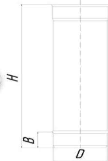
Труба одностінна з нержавіючої сталі призначена для видалення димових газів і є основним елементом димохідної системи.
