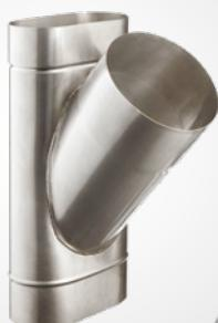
Трійник 45° призначений для приєднання до димохідної системи під кутом 45°. А також може використовуватися як конденсатовідвідник (в разі доукомплектування лійкою).
