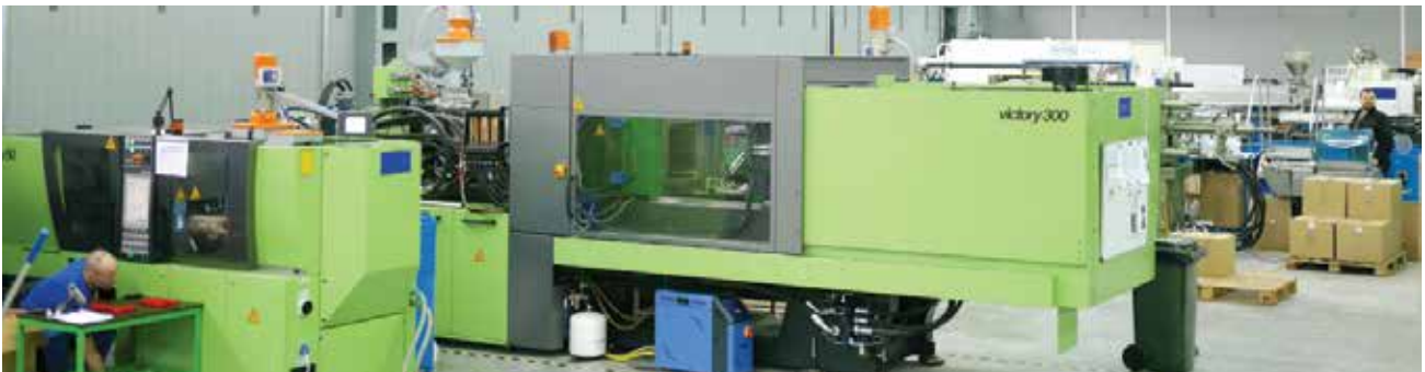
Цех лиття пластмас (для таких продуктів як фільтри-гличики, корпуси фільтрів, кронштейни тощо)
