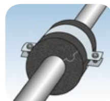
4 - Установите металлический хомут на подвес. Монтажный разрез подвеса обязательно должен быть ориентирован горизонтально, независимо от ориентации металлического хомута.
