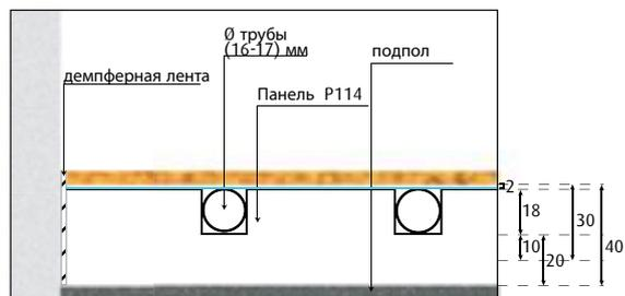
ОПИСАНИЕ: Система «сухого» теплого пола состоит из сэндвич-панели которая с одной стороны состоит из расширенного полистерена, а с другой из тонкого листа фольги который отражает тепло. Система предусматривает монтаж трубы 16-17мм. Традиционная цементная стяжка, на которую укладывается финишное покрытие, заменена двойным слоем оцинкованного листа (2мм толщиной) который обеспечивает отличную теплопроводность и высокое механическое сопротивление.
