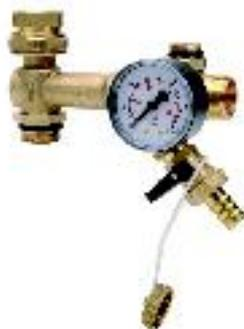
Соединение для геосистемы в сборе. В комплект входит: манометр 0-6 бар, сливной кран, подключение G1/2 для предохранительного крана, подключение G3/4" для трубы расширительного бака. Соединение с плоской прокладкой с одной стороны, и внутренняя резьба G3/4" с другой.
