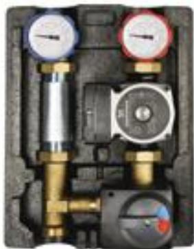
**Насосная группа с автоматической регулировкой.** В комплекте: -3-ходовой смеситель управляемый роторным электрическим трехпозиционным бинаправленным сервомотором для подключения к котельной. Смеситель оснащен байпасом для забора части воды из обратной линии системы и для дальнейшего подмеса в прямую линию для обеспечения равномерной температуры в системе.
