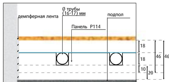
ОПИСАНИЕ: Система «сухого» теплого пола состоит из сэндвич-панели которая с одной стороны состоит из расширенного полистерена, а с другой из тонкого листа фольги который отражает тепло. Система предусматривает монтаж трубы 16-17мм. Традиционная цементная стяжка, на которую укладывается финишное покрытие, заменена панелью из гипсоволокна.
