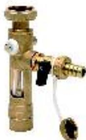
Расходомер для геосистемы. Расход 0-13 лит./мин. или 0-8 лит./мин. Накидная гайка с плоской прокладкой с одной стороны, и внутренняя резьба G3/4" с другой.
