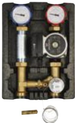
**Насосная группа с фиксируемой регулировкой.** В комплекте: 3-ходовой смеситель управляемый термоголовкой АРТ. 995 с выносным датчиком, который крепится к трубе или погружается в трубу прямой линии. Шкала регулировки 20° - 50°. Смеситель оснащен байпасом для забора части воды из обратной линии системы и для дальнейшего подмеса в прямую линию для обеспечения равномерной температуры в системе.
